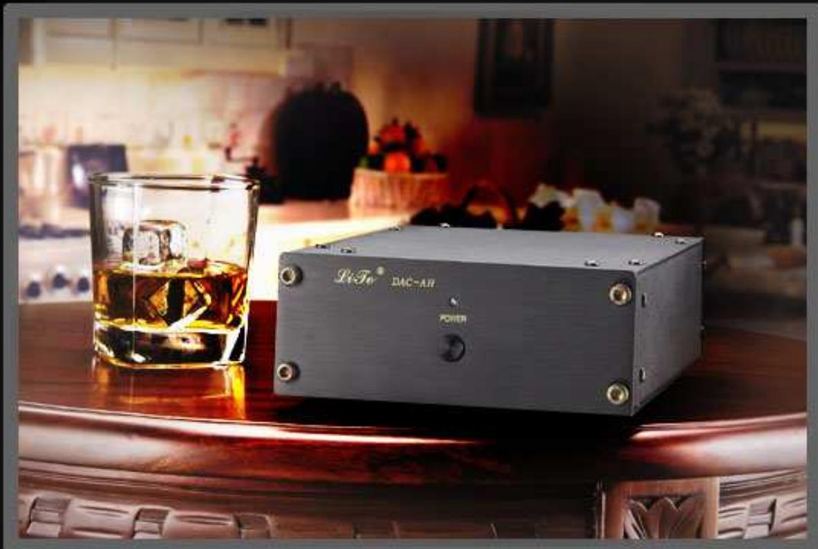
感謝您購買本站 DAC-AH DAC 成品機。DAC-AH 是以 PHILIPS TDA 1543 Silver Crown 這顆晶片為主體，經過試聽比較之後，原廠決定以八顆來並聯，可以達到高頻豐富，且音樂性最佳的聽感。接收晶片，當然選用目前最佳的 CS8414。輸出低通濾波使用發燒級高速運算放大器。如此來完成 DAC-AH 的主要架構，晶片皆是一時之選，想必效果不凡。
